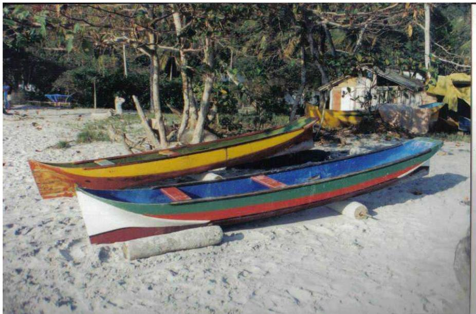
**Bote:** pequenas lanchas de fibra a motor. Em geral os botes utilizados para funções semelhantes as da canoa, sobretudo na pesca. Leva no máximo quatro pessoas.
